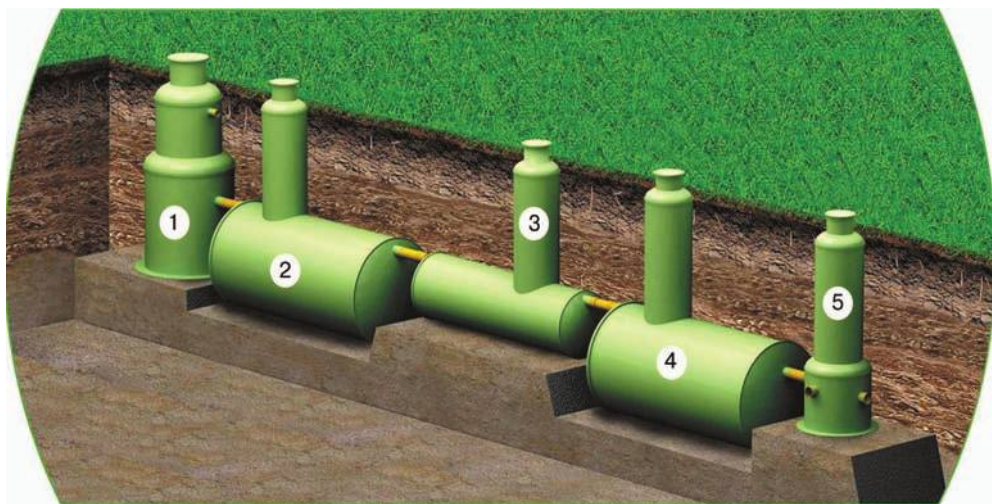
Рис. 6.4. Пример современного очистительного сооружения: 1 – распределительный колодец; 2 – отделитель твердых частиц; 3 – отделитель жиросодержащих веществ; 4 – сорбционный фильтр; 5 – контрольный колодец
